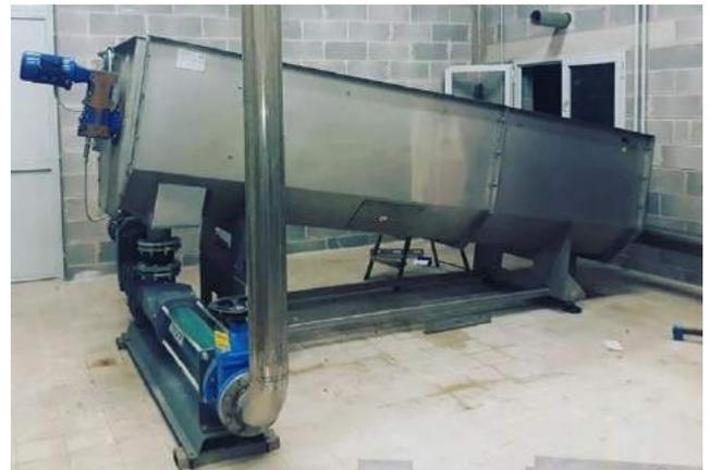
Dans le cas de l'épaississeur, après avoir atteint la zone de décharge, les boues sont acheminées vers la sortie en bas de l'équipement. La sortie peut être raccordée à une pompe de transfert jusqu'à un éventuel système de déshydratation. Pour la presse à vis de déshydratation, une fois passé dans le système de contre-pression pneumatique, la boue est évacuée dans une benne à ordures ou convoyé par une vis de transport.
