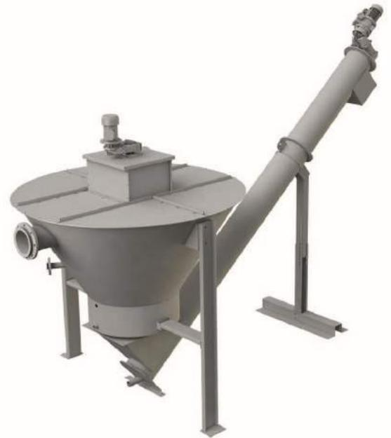
Le fond de la trémie est alimenté en eau propre et crée un contre-courant qui pousse les matières organiques afin d'être évacuée par un tuyau placé sur la partie supérieure de la trémie.
