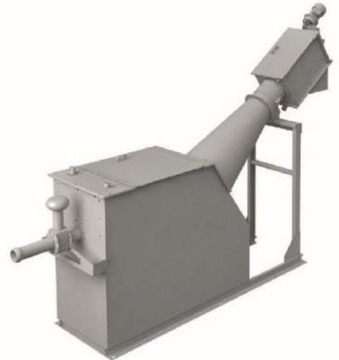
L'équipement est composée d'une connexion rapide, d'un robinet à tournant sphérique motorisé automatique et d'un tamis à vis avec une zone de compactage. À l'intérieur du réservoir est installé un capteur de niveau afin de contrôler la hauteur d'eau et réguler avec la vanne automatique. La zone de tamisage, de transport et de compactage est équipée d'un système de lavage afin d'éliminer toutes les parties organiques avant la décharge.
